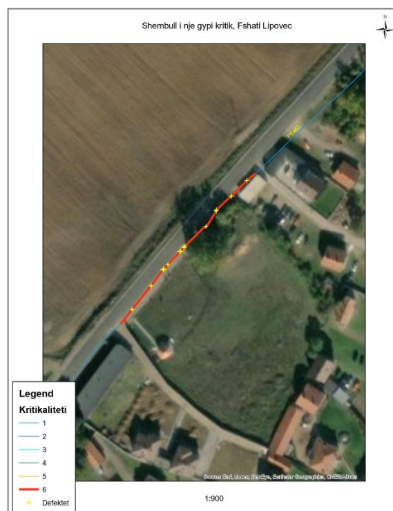
Figura 29. Shembuj të klasifikimit dhe paraqitjes së gypave kritik nga rezultati i analizës me Model Builder
